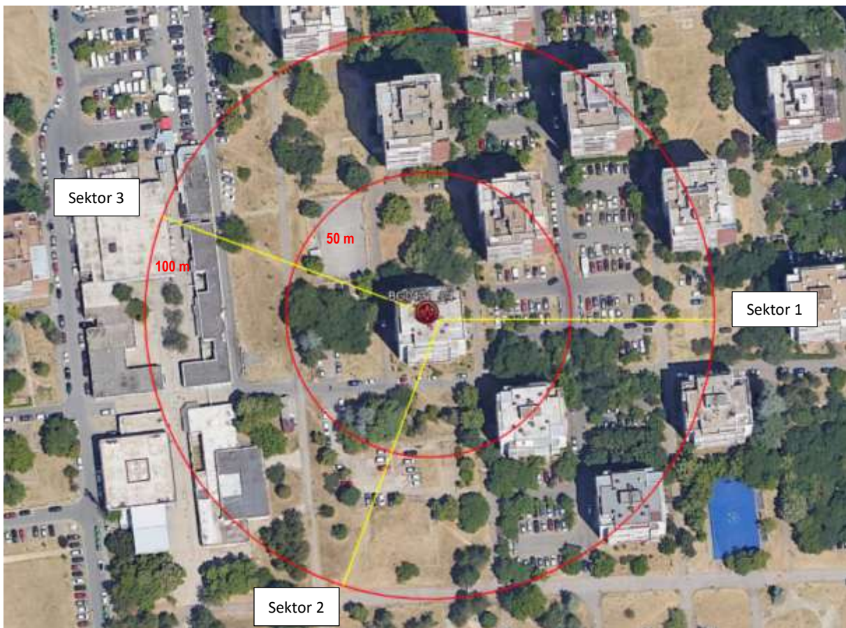
Slika 2.7 Pravci zračenja antenskih sistema predmetne bazne stanice
