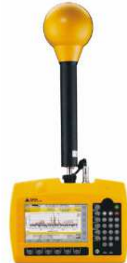
Širokopoljarni instrument za merenje jačine el. polja
