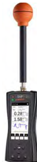
Širokopolasni instrument za merenje jačine el. polja
