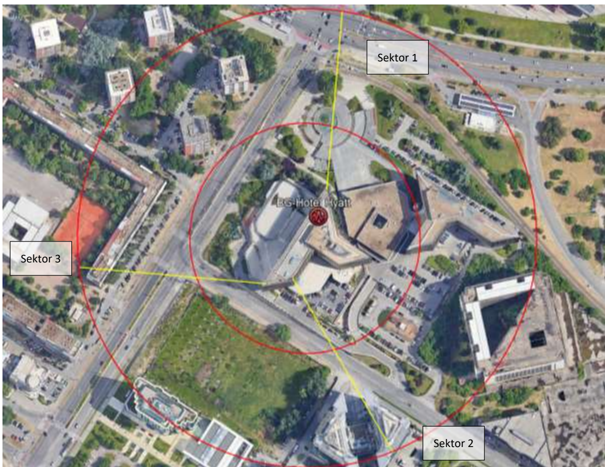
Slika 2.7 Pravci zračenja antenskih sistema predmetne bazne stanice
