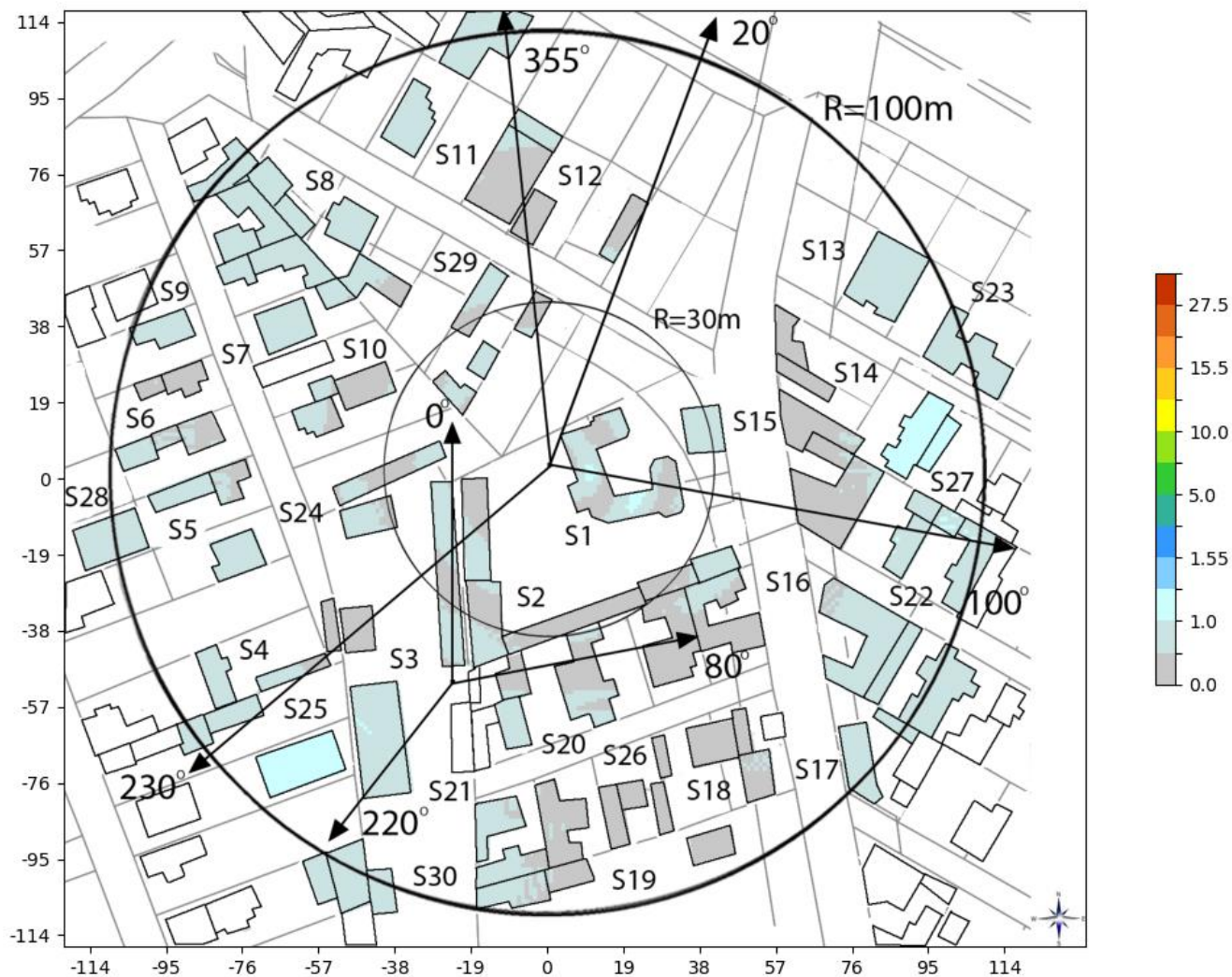
Slika 6.1: Rezultati proračuna jačine električnog polja unutar objekata, kada LTE800 bazna stanica operatora MTS radi sa maksimalnim kapacitetom.
