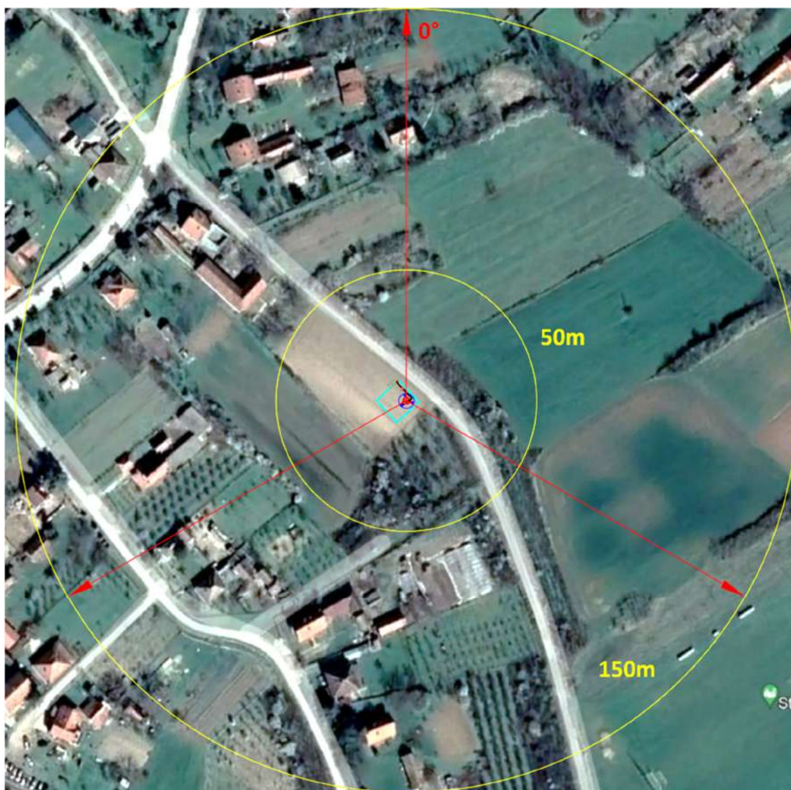
Slika 5.1. Dijagram zračenja raio bazne stanice «BG0371_01 BG_Obrenovac_Skela»
