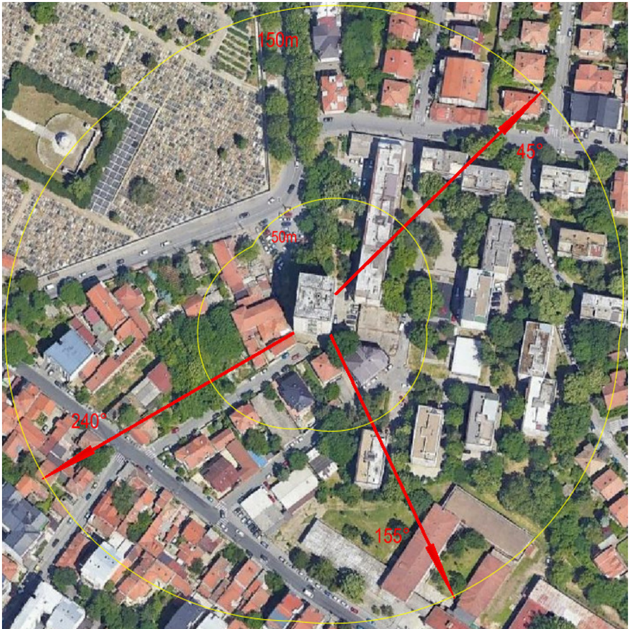
Slika 2.1 Dijagram zračenja radio bazne stanice „BG - Veljka Dugoševića II” - BG744/BGU744/BGL744/BGO744/BGJ744
